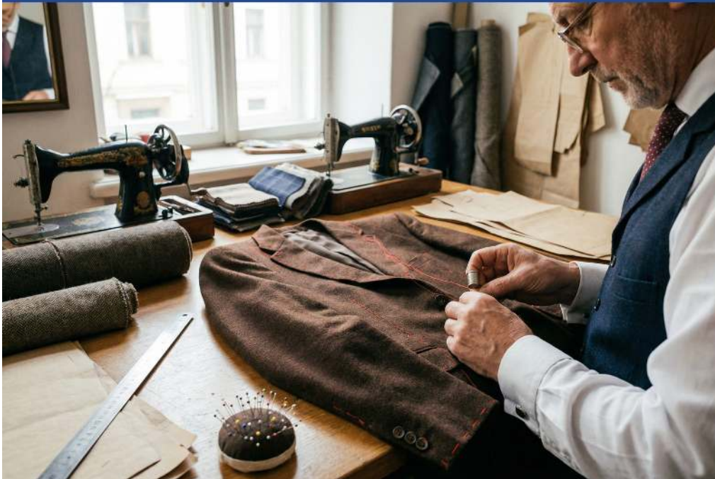
Utilisation du fil de bâti contrasté pour un repérage précis des coutures
